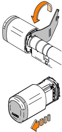
Mit dem Öffnungswerkzeug SP225542 den Bajonettverschluss lösen und Kappe abziehen.
