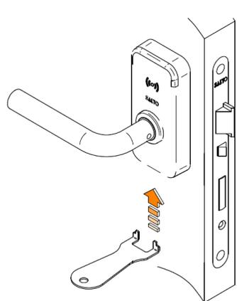
Mit dem Batteriewechselwerkzeug SP221457 die zwei Kunststoffclips an der Unterseite betätigen.
