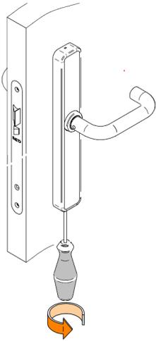
Schraube an der Unterseite des Innenteils hineindrehen.
