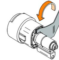
Mit dem Öffnungswerkzeug SP225542 den Bajonettverschluss lösen und Kappe abziehen.
