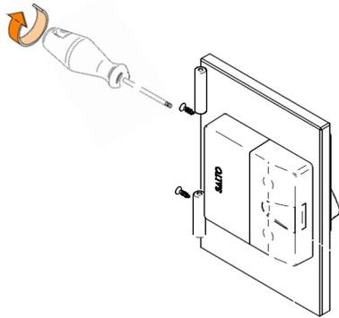
Die zwei TR-Torx 15 Schrauben auf der Innenseite entfernen
