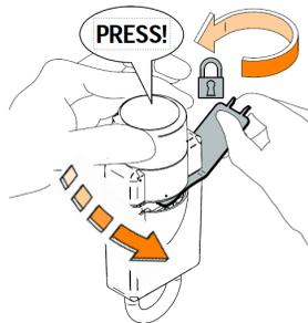
Zylinderkappe wieder aufsetzen und Bajonettverschluss schließen.
